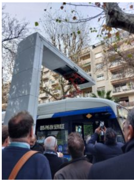
Recharge d'un bus par pantographe
