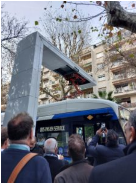
Recharge d'un bus par pantographe
