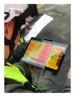
Déjà utilisée sur d'autres réseaux en France, la thermographie par drone convainc de nouveaux utilisateurs, notamment la CCIAG qui en a fait l'expérience le 3 décembre. Le drone équipé d'une caméra thermique infrarouge a survolé le quartier Capuche-Alliés de Grenoble et a pu détecter une fuite d'environ 10 m3/jour qui n'avait pu être identifiée par thermographie traditionnelle.
