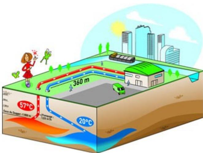
Chargée de la production et de la distribution de chauffage par eau chaude ou par vapeur, la société d'économie mixte CPCU envisage d'utiliser la ressource géothermale souterraine. Les travaux de forage ont débuté pour aller puiser l'eau naturellement à 57° dans le dogger, couche géologique enfouie à environ 1 800 mètres de profondeur, sous le site de la Zac Claude-Bernard, en bordure du périphérique et du canal Saint-Martin.
